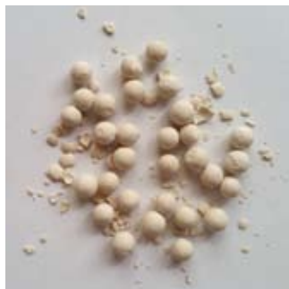
Рис. 3. Разрушенные гранулы сорбента в результате бурной экзотермической реакции
