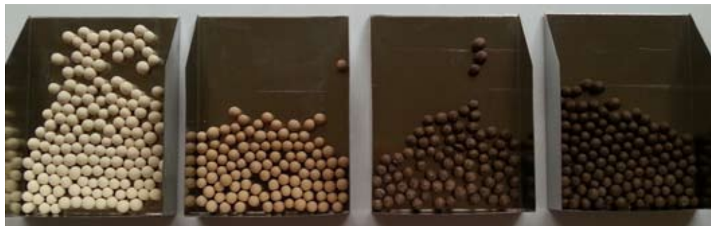
Рис. 4. Загрязнение поверхности сорбента в процессе циклического осушения угольного шлама
